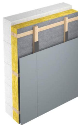
Figura 1.1b: Placas Hardie® Panel fijadas a subestructura de madera.
