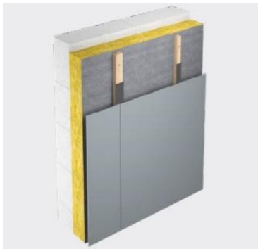
Figura 4.2a: Subestructura con rastreles verticales de madera.
