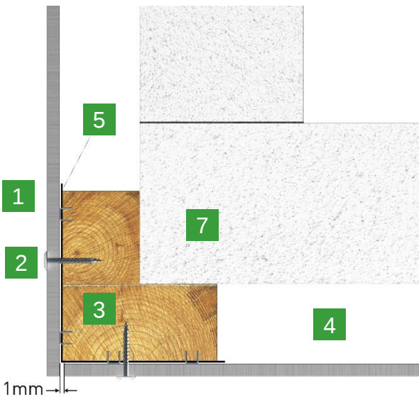
Figura 5.2.10: Sección horizontal. Esquina saliente.
