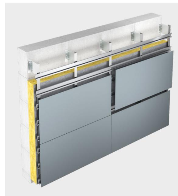
Los paneles de fachada se cuelgan en orden ascendente, lo cual permite un ajuste preciso mediante las grapas del tipo B y C, fijados en la fila de coronación del panel. También permite la instalación del punto fijo utilizando la grapa del tipo C a través del tornillo de fijación que se inserta en la grapa.
