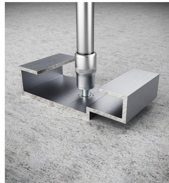
A continuación se coloca la grapa sobre la cabeza del taco y se atornilla el tornillo Hardie™ Panel Oculto, aplicando una ligera presión sobre la grapa para fijar el taco en su posición. La superficie inferior dentada de la cabeza del tornillo se incrusta en la grapa para asegurar la fijación.
